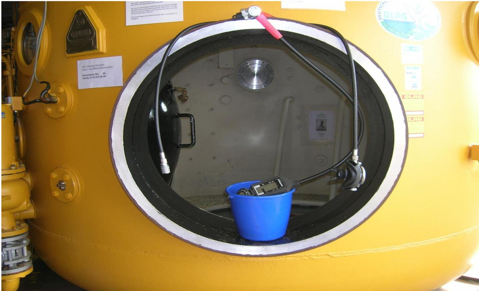
In der Turmkammer müssen Tauchcomputer während der Kompression und Dekompression ins Wasser.
