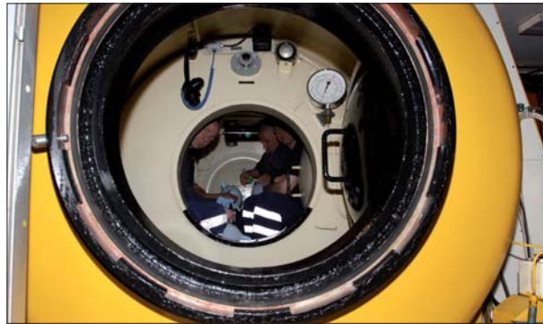
Enge Kammer: In der Überdruckkammer oberhalb des Tauchturms haben bis zu sechs Personen Platz.
