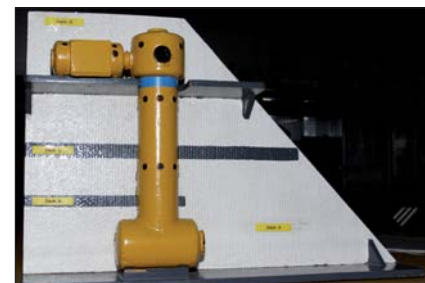
Überblick: Nur ein Modell kann die Lage der Überdruckkammer und des Tauchturms verdeutlichen. Die Anlage erstreckt sich über vier Geschosse. Die unteren zwei Bereiche sind mit Wasser und der obere Teil (Höhe Deck D; oberhalb der blauen Markierung) mit Luft gefüllt.
